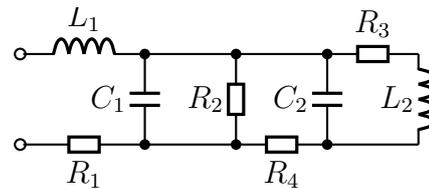
**Lösung:** Zur Lösung bestimme ich zunächst die entsprechenden Blindwiderstände aus der Kreisfrequenz und den  $L$ - und  $C$ -Werten.
