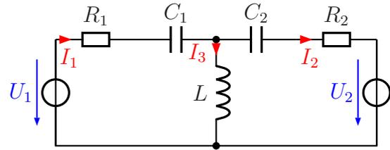
**Lösung:** Vorweg können  $R_1$  und  $C_1$  zu  $Z_1$  und  $R_2$  und  $C_2$  zu  $Z_2$  zusammengefasst werden.
