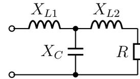
**Lösung:** Um das Problem lösen zu können, stelle ich die Formel auf, mit deren Hilfe  $\underline{Z}$  aus den Blind- und Wirkwiderständen bestimmt wird. Dabei setze ich die unbekanntenen Größen  $\underline{X}_{L1}$  und  $\underline{X}_C$  an mit:
