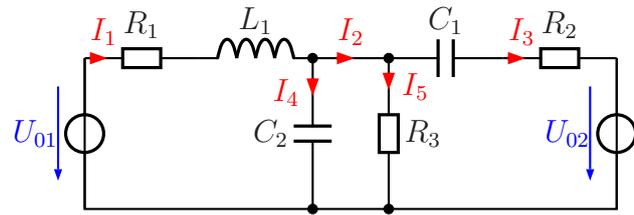
**Lösung:** Zunächst stelle ich die gegebenen Größen als komplexe Werte auf. Da beide Spannungen die gleiche Phasenlage haben, lege ich die Spannungen entlang der reellen Achse fest:
