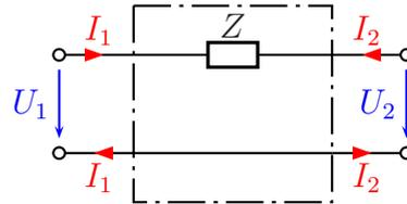
$$\underline{Z} \text{ existiert nicht} \quad \underline{Y} = \begin{pmatrix} \frac{1}{Z} & -\frac{1}{Z} \\ -\frac{1}{Z} & \frac{1}{Z} \end{pmatrix} \quad \underline{H} = \begin{pmatrix} Z & 1 \\ -1 & 0 \end{pmatrix}$$
