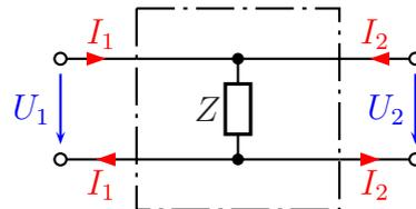
$$\underline{Z} = \begin{pmatrix} Z & -Z \\ -Z & Z \end{pmatrix} \quad \underline{Y} \text{ existiert nicht} \quad \underline{H} = \begin{pmatrix} 0 & 1 \\ -1 & \frac{1}{Z} \end{pmatrix}$$
