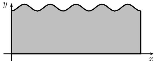
Das Gewindeprofil hat die Form einer Sinuskurve. Der Außendurchmesser eines Gewindes nach E27 beträgt 27 mm, der Kerndurchmesser 24,5 mm und die Gewindesteigung (Abstand zweier benachbarten Gewindegänge) 3,62 mm.
