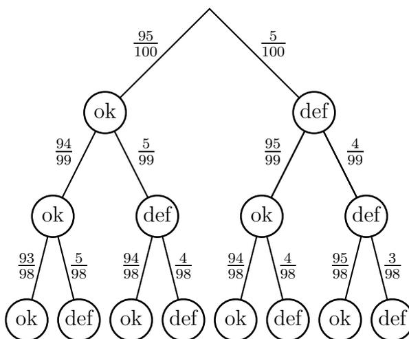
Sinnvollerweise arbeitet man hier mit der **Gegenwahrscheinlichkeit**. Dazu bestimmt man zunächst die Wahrscheinlichkeit für 3 intakte Transistoren und subtrahiert das Ergebnis von 1.
