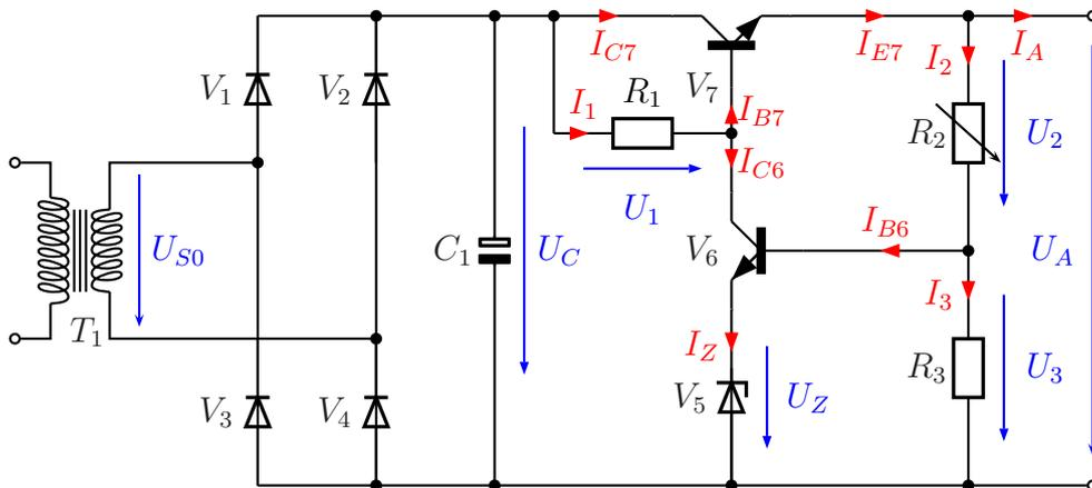
Oben dargestellte Schaltung stellt ein einstellbares stabilisiertes Netzteil dar. An die Schaltung werden folgende Anforderungen gestellt:
