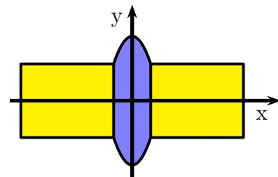
Der Rotationskörper kann nun in drei Teile zerlegt werden, das blau markierte Mittelteil mit der parabelförmigen Begrenzungslinie und die beiden gelb markierten zylindrischen Randstücke. Diese Randstücke können zu einem einzigen Zylinder mit 50 mm Länge und 20 mm Durchmesser zusammengelegt und separat auf klassische Weise berechnet werden. Für das Mittelteil kommt die Integralformel für Rotationskörper zum Einsatz.
