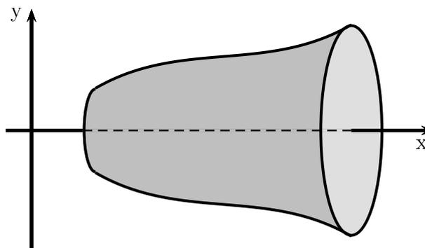
Nebenstehend ist ein Beispiel dazu dargestellt. Die Oberkante stellt eine beliebige Funktion  $f(x)$  dar. Durch Rotation um die  $x$ -Achse beschreibt dieser Funktionsgraph die Oberfläche des Drehkörpers. Links und rechts ist der Drehkörper durch einen senkrechten Schnitt begrenzt.
