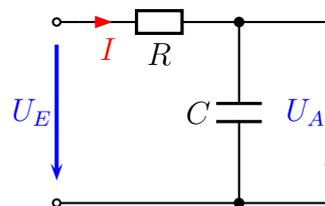
Nehmen Sie nun die Messreihe auf. Stellen Sie dazu jeweils eine geeignete Eingangsspannung  $U_E$  ein und messen Sie die Ausgangsspannung  $U_A$  sowie deren Phasenverschiebung  $\varphi$  gegenüber der Eingangsspannung. Diese Werte protokollieren Sie in nachfolgender Wertetabelle. Dies führen Sie für jede vorgegebene Frequenz durch.
