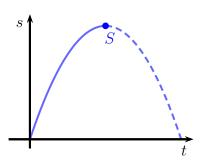
Funktion für den Bremsvorgang. Würde weiterhin eine Kraft wie die Bremskraft am Fahrzeug nach hinten ziehen, dann würde sich das Fahrzeug rückwärts beschleunigen und dem gestrichelten Kurvenverlauf folgen. Da das aber nicht passiert, ist der Kurvenverlauf hier nur gestrichelt eingezeichnet.
