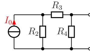
Als nächstes kann die Stromquelle mit dem Innenwiderstand  $R_2$  in eine Spannungsquelle mit Innenwiderstand  $R_2$  umgewandelt werden.
