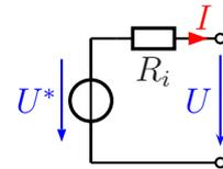
Die Ersatzspannung  $U^*$  ist gleich der Leerlaufspannung des Spannungsteilers.
