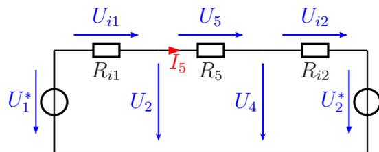
Beginnen wir mit der Umrechnung des linken Spannungsteilers. Der Innenwiderstand  $R_{i1}$  stellt die Parallelschaltung  $R_1 \parallel R_2$  dar.
