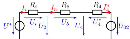
$$U^* = \frac{U_{01} \cdot R_2}{R_1 + R_2} = \frac{15 \text{ V} \cdot 2,4 \Omega}{1,6 \Omega + 2,4 \Omega} = 9 \text{ V}$$
