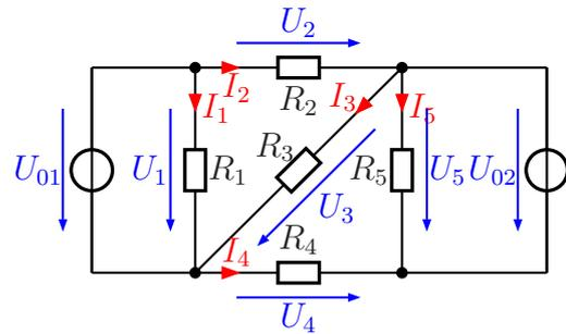
**Lösung:** Betrachten wir zunächst den Widerstand  $R_1$ . Er ist direkt an  $U_{01}$  angeschlossen. Der Strom, der hindurchfließt, hat auf keine anderen Ströme einen Einfluss. Er kann also vorweg unabhängig berechnet werden. Das gleiche gilt auch für  $R_5$  an  $U_{02}$ .
