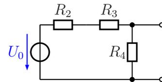
Nun kann die Schaltung – die ja eine Spannungsteilerschaltung darstellt – in die gesuchte Spannungsquelle mit Innenwiderstand umgerechnet werden.
