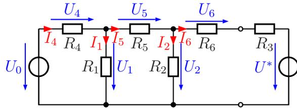
Nebenstehend ist die Struktur der Schaltung mit einem Vollständigen Baum dargestellt. Da es sich wiederum sinngemäß um die gleiche Struktur, wie bei Aufgabe 3 handelt, verzichte ich hier auf die Darstellung der Alternativen. Der Baum wurde entsprechend der Faustregel durch die Spannungsquellen gelegt. Die Maschengleichungen können aufgestellt werden.
