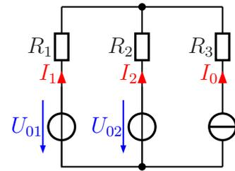
**Lösung:** Man könnte auf die Idee kommen, die Stromquelle in eine Spannungsquelle umzuwandeln. Das ist aber nicht möglich, weil die Stromquelle keinen Parallelwiderstand hat, der sich als Innenwiderstand interpretieren lässt. Damit scheidet das Maschenstromverfahren als Lösungsmethode aus. Man kann aber beide Spannungsquellen in Stromquellen umwandeln, wenn man das möchte. Damit erhalten wir zwei mögliche Lösungsverfahren:
