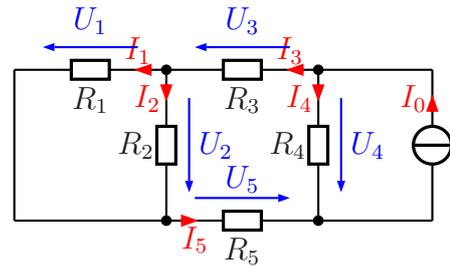
**Lösung:** Zunächst kann die Stromquelle  $I_0$  mit dem Widerstand  $R_4$  in eine Spannungsquelle mit Innenwiderstand umgewandelt werden. Dabei bleibt  $R_4$  unverändert der Innenwiderstand.
