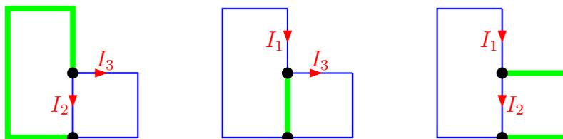
Obenstehend sind drei Möglichkeiten für einen Vollständigen Baum dargestellt. Je nachdem, wie der Baum gelegt wurde, ergeben sich unterschiedliche Maschenströme. **Nur die Verbindungszweige** bilden die Maschenströme! Im linken Fall sind das  $I_2$  und  $I_3$ , im mittleren Fall  $I_1$  und  $I_3$  und im rechts dargestellten Fall  $I_1$  und  $I_2$ .
