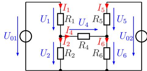
Weiterhin hat der Strom  $I_3$  keinen Einfluss auf den Rest der Schaltung, so dass  $R_3$  für die weiteren Berechnungen entfernt werden kann.
