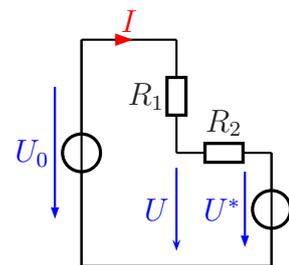
$$U^* = R_2 \cdot I_0 = 30 \Omega \cdot 0,2 \text{ A} = 6 \text{ V}$$
