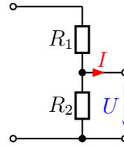
Ergänzen Sie zunächst die Schaltung um die reale Spannungsquelle. Wandeln Sie dann die gesamte Schaltung in eine Spannungsquelle mit Innenwiderstand um. Wie groß ist der Innenwiderstand  $R_i^*$  und die Urspannung  $U^*$  dieser Ersatzschaltung?
