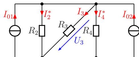
In dieser Schaltung werden die drei Widerstände zu  $R_{ges}$  zusammengefasst. Entsprechend werden auch die beiden Ströme  $I_{01}$
