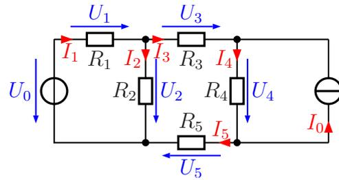
**Lösung:** Zunächst wird die Stromquelle  $I_0$  in eine Spannungsquelle umgewandelt. Nebenstehend ist die Umwandlung dargestellt. Darin arbeitet  $R_4$  als Innenwiderstand der Stromquelle und taucht daher auch als Innenwiderstand der Spannungsquelle wieder auf. Die Urspannung dieser Ersatzspannungsquelle habe ich mit  $U^*$  bezeichnet. Diese Spannung kann mit Hilfe des Ohmschen Gesetzes aus dem Urstrom  $I_0$  und dem Innenwiderstand der Stromquelle  $R_4$  berechnet werden.
