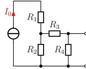
**Lösung:** Der Widerstand  $R_1$ , der in Reihe zur Stromquelle geschaltet ist, hat auf den Rest der Schaltung keinerlei Einfluss, da er zur Stromquelle **in Reihe** geschaltet ist. Daher kann er für die weitere Betrachtung weggelassen werden.
