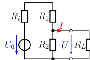
In der neuen Ersatzschaltung kann nun die Schaltgruppe bestehend aus  $U_0$ ,  $R_{i1}$  und  $R_2$  in eine neue Spannungsquelle mit der Spannung  $U^*$  und dem Innenwiderstand  $R_i^*$  umgerechnet werden. Beginnen wir mit dem Innenwiderstand  $R_i^*$ .
