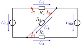
$U_{01}$  mit  $R_2$  kann dann als Spannungsquelle mit Innenwiderstand betrachtet werden. Das gleiche gilt auch für  $U_{02}$  mit  $R_4$ .
