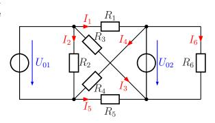
**Lösung:** Für diese Aufgabe empfiehlt sich das Maschenstromverfahren. Den von mir gewählten Baum habe ich nebenstehend eingezeichnet. Er verläuft entprechend der allgemeinen Empfehlung durch die beiden Spannungsquellen. Allerdings kann man zuvor direkt schon die Ströme  $I_2$  und  $I_6$  berechnen, da sie unmittelbar an die Spannungsquellen  $U_{01}$
