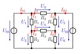
**Lösung:** Der Widerstand  $R_3$  ist zwischen die beiden Spannungsquellen geschaltet. Das bedeutet, dass die Spannung  $U_3$  und der Strom  $I_3$  sofort bestimmt werden kann.
