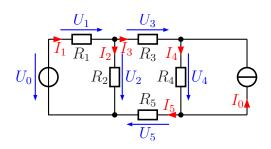
**Lösung:** Zunächst wird die Stromquelle  $I_0$  in eine Spannungquelle umgewandelt. Nebenstehend ist die Umwandlung dargestellt. Darin arbeitet  $R_4$  als Innenwiderstand der Stromquelle und taucht daher auch als Innenwiderstand der Spannungsquelle wieder auf. Die Urspannung dieser Ersatzspannungsquelle habe ich mit  $U^*$  bezeichnet. Diese Spannung kann mit Hilfe
