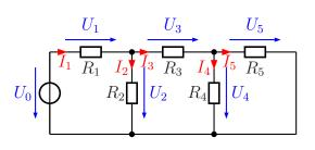
**Lösung:** Zunächst wandle ich den Spannungsteiler (bestehend aus  $U_0$ ,  $R_1$  und  $R_2$ ) in eine Spannungsquelle mit Innenwiderstand um.
