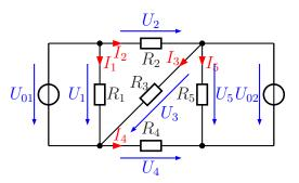
**Lösung:** Betrachten wir zunächst den Widerstand  $R_1$ . Er ist direkt an  $U_{01}$  angeschlossen. Der Strom, der hindurchfließt, hat auf keine anderen Ströme einen Einfluss. Er kann also vorweg unabhängig berechnet werden. Das gleiche gilt auch für  $R_5$  an  $U_{02}$ .
