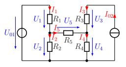
**Lösung:** Die Stromquelle kann in eine Spannungsquelle mit Innenwiderstand umgewandelt werden. Dabei hat der Widerstand  $R_3$  keine Funktion; der Strom  $I_{02}$  fließt ungehindert durch ihn hindurch, unabhängig von seinem Widerstandswert. Damit ist nur  $R_4$  der Innenwiderstand der Stromquelle und taucht somit als einziger Widerstand in dem umgewandelten Schaltungsteil auf.
