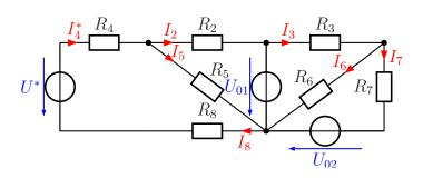
voll, die Stromquelle in eine Spannungsquelle umzurechnen. Dabei entfällt der Widerstand  $R_1$  ersatzlos, denn der Strom aus der Stromquelle fließt unbeeindruckt von  $R_1$ . Zu beachten ist, dass der Strom  $I_4^*$  in dieser Ersatzschaltung nicht identisch ist mit dem Strom  $I_4$  aus der Originalschaltung. Obenstehend ist die sich ergebende Schaltung dargestellt.
