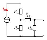
**Lösung:** Der Widerstand  $R_1$ , der in Reihe zur Stromquelle geschaltet ist, hat auf den Rest der Schaltung keinerlei Einfluss, da er zur Stromquelle **in Reihe** geschaltet ist. Daher kann er für die weitere Betrachtung weggelassen werden. **Begründung:** Die ideale Stromquelle hat einen unendlich großen Innenwiderstand. Da bewirken ein paar Ohm (oder auch Kiloohm) in Reihe keine Veränderung.
