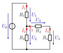
**Lösung:** Es erscheint zweckmäßig, zunächst den Spannungsteiler  $R_1/R_2$  in eine Spannungsquelle mit Innenwiderstand umzurechnen.
