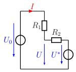
Berechnen wir zunächst  $U^*$ . Das ist die **Leerlaufspannung** an  $R_2$ , wenn nur  $I_0$  angschlossen ist.
