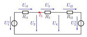
zu beachten, dass hierin nur im Mittelteil – also um  $R_5$  herum – noch die Original-Spannungen und -Ströme auftreten. Dies sind die eingezeichneten Spannungen  $U_2$ ,  $U_5$  und  $U_4$  sowie der Strom  $I_5$ .
