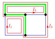
Nebenstehend ist einer von mehreren möglichen geeigneten Maschenplänen mit einem vollständigen Baum dargestellt. Damit können die Maschengleichungen aufgestellt werden.
