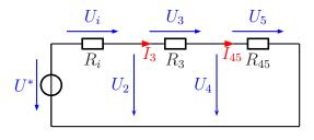
$$I_3 = I_{45} = \frac{U^*}{R_i + R_3 + R_{45}} = \frac{2,4 \text{ V}}{800 \Omega + 3,1 \text{ k}\Omega + 900 \Omega} = 0,5 \text{ mA}$$
