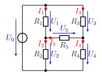
**Lösung:** Hier können **beide** Spannungsteiler (zum einen  $R_1/R_2$ , zum anderen  $R_3/R_4$ ) in jeweils eine Spannungsquelle mit Innenwiderstand umgerechnet werden. Dabei spielt es keine Rolle, dass beide Spannungsteiler durch die gleiche Quelle ( $U_0$ ) gespeist werden. Führt man das durch, erhält man das nebenstehende Ersatzschaltbild. Hierbei ist
