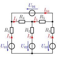
Lösung: Wir haben keine Stromquellen, sondern ausschließlich Spannungsquellen. Deshalb bietet sich das Maschenstromverfahren an. In einer Schaltung mit vier Quellen wäre zudem die Anwendung des Überlagerungssatzes recht aufwändig.
