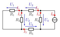
**Lösung:** Zunächst kann die Stromquelle  $I_0$  mit dem Widerstand  $R_4$  in eine Spannungsquelle mit Innenwiderstand umgewandelt werden. Dabei bleibt  $R_4$  unverändert der Innenwiderstand.
