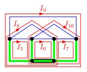
nem "Überknoten" zusammengefasst. Ich habe den Baum gemäß der Faustregel durch die vier Spannungquellen gelegt. Damit ergeben sich die hier dargestellten Maschenströme. Die Maschengleichungen können aufgestellt werden. (Aus Platzgründen sind die Gleichungen nicht mit einer Gleichungsnummer versehen.)
