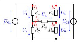
Weiterhin hat der Strom  $I_3$  keinen Einfluss auf den Rest der Schaltung, so dass  $R_3$  für die weiteren Berechnungen entfernt werden kann.
