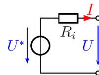
Die Ersatzspannung  $U^*$  ist gleich der Leerlaufspannung des Spannungsteilers.
