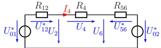
Genau das gleiche kann auch mit dem Spannungsteiler  $R_5/R_6$  und der Spannungsquelle  $U_{02}$  gemacht werden. Wir erhalten die Spannung  $U_{02}^*$  und den Widerstand  $R_{56}$ .
