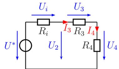
Der Strom  $I_3 = I_4$  kann mit Hilfe des Ohmschen Gesetztes aus  $U^*$  und der Reihenschaltung  $R_i/R_3/R_4$  bestimmt werden.
