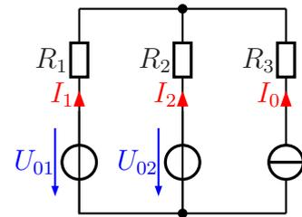
**Lösung:** Man könnte auf die Idee kommen, die Stromquelle in eine Spannungsquelle umzuwandeln. Das ist aber nicht möglich, weil die Stromquelle keinen Parallelwiderstand hat, der sich als Innenwiderstand interpretieren lässt. Damit scheidet das Maschenstromverfahren als Lösungsmethode aus. Man kann aber beide Spannungsquellen in Stromquellen umwandeln, wenn man das möchte. Damit erhalten wir zwei mögliche Lösungsverfahren:
