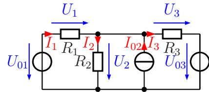
**Lösung:** Hier bietet es sich an, die beiden Spannungsquellen in Stromquellen umzuwandeln. Dann sind nämlich alle Widerstände und alle Stromquellen miteinander parallelgeschaltet.
