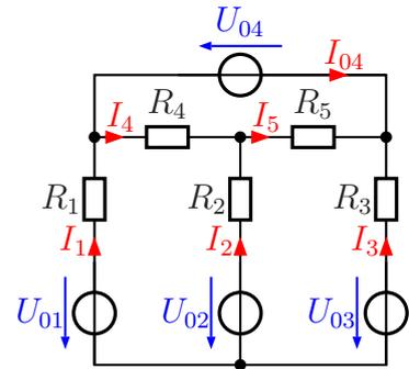
**Lösung:** Wir haben keine Stromquellen, sondern ausschließlich Spannungsquellen. Deshalb bietet sich das Maschenstromverfahren an. In einer Schaltung mit **vier** Quellen wäre zudem die Anwendung des Überlagerungssatzes recht aufwändig.
