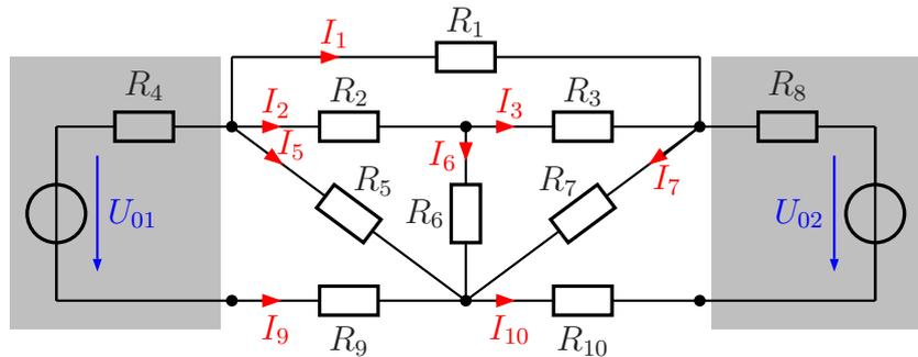
Bestimmen wir zunächst die Ersatzspannungen  $U_{01}$  und  $U_{02}$ . Sie stellen die Leerlaufspannungen der Stromquellen  $I_{01}$  und  $I_{02}$  mit den zugehörigen Innenwiderständen  $R_4$  und  $R_8$  dar.
