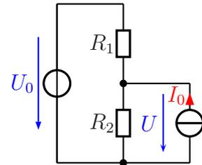
**Lösungsvariante 1:** Der Schaltungsteil bestehend aus  $R_2$  und  $I_0$  wird ersetzt durch eine Ersatzspannungsquelle  $U^*$  mit Innenwiderstand. Dieser Innenwiderstand bleibt  $R_2$ .
