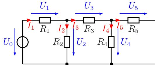
**Lösung:** Zunächst wandle ich den Spannungsteiler (bestehend aus  $U_0$ ,  $R_1$  und  $R_2$ ) in eine Spannungsquelle mit Innenwiderstand um.
