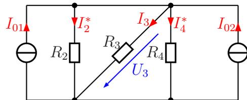
In dieser Schaltung werden die drei Widerstände zu  $R_{ges}$  zusammengefasst. Entsprechend werden auch die beiden Ströme  $I_{01}$  und
