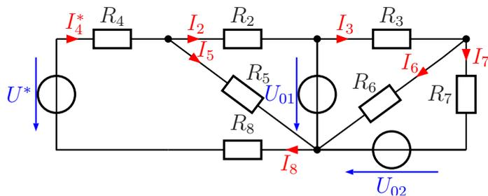
Die Widerstände  $R_4$  und  $R_8$  können zu einem einzigen zusammengefasst werden mit  $R_{48} = R_4 + R_8 = 15 \text{ k}\Omega$ . Für die weitere Vorgehensweise sind jetzt für beide Schaltungsteile unabhängig voneinander mehrere Varianten denkbar.
