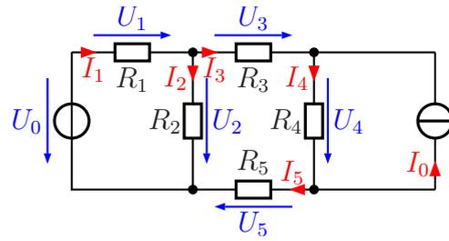
**Lösung:** Zunächst wird die Stromquelle  $I_0$  in eine Spannungsquelle umgewandelt. Nebenstehend ist die Umwandlung dargestellt. Darin arbeitet  $R_4$  als Innenwiderstand der Stromquelle und taucht daher auch als Innenwiderstand der Spannungsquelle wieder auf. Die Urspannung dieser Ersatzspannungsquelle habe ich mit  $U^*$  bezeichnet. Diese Spannung kann mit Hilfe des Ohmschen Gesetzes aus dem Urstrom  $I_0$  und dem Innenwiderstand der Stromquelle  $R_4$  berechnet werden.
