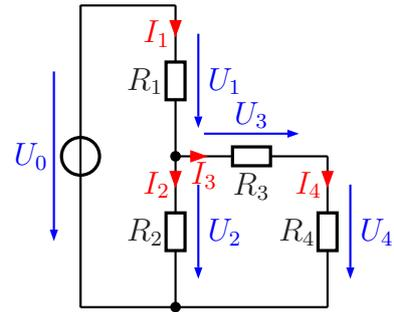
**Lösung:** Es erscheint zweckmäßig, zunächst den Spannungsteiler  $R_1/R_2$  in eine Spannungsquelle mit Innenwiderstand umzurechnen.
