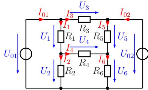
**Lösung:** Der Widerstand  $R_3$  ist zwischen die beiden Spannungsquellen geschaltet. Das bedeutet, dass die Spannung  $U_3$  und der Strom  $I_3$  sofort bestimmt werden kann.
