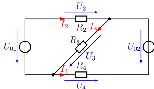
Man kann nun diese beiden Spannungsquellen in Stromquellen umwandeln, dann sind alle Widerstände parallelgeschaltet, die Berechnung wird einfach.
