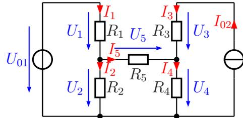
**Lösung:** Die Stromquelle kann in eine Spannungsquelle mit Innenwiderstand umgewandelt werden. Dabei hat der Widerstand  $R_3$  keine Funktion; der Strom  $I_{02}$  fließt ungehindert durch ihn hindurch, unabhängig von seinem Widerstandswert. Damit ist nur  $R_4$  der Innenwiderstand der Stromquelle und taucht somit als einziger Widerstand in dem umgewandelten Schaltungsteil auf.
