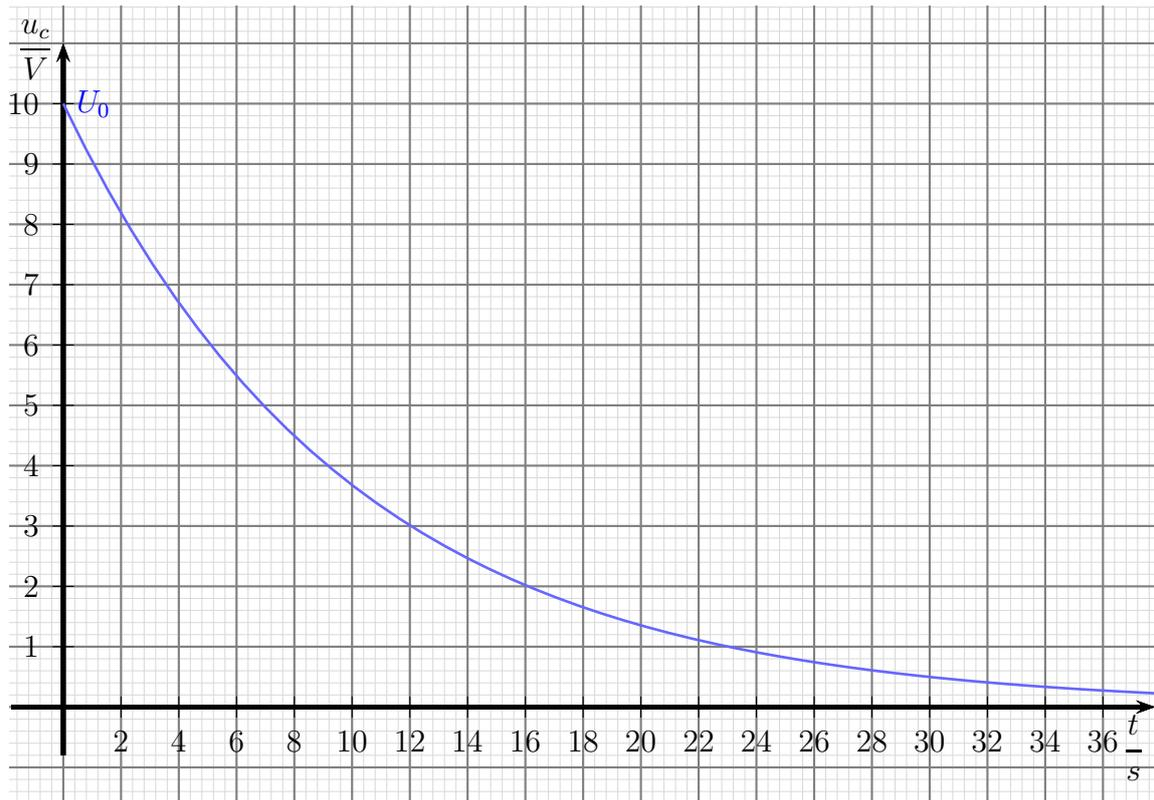
Man sieht, dass sich der Kondensator zunächst schnell, dann immer langsamer entlädt. Die Entladekurve nähert sich mit der Zeit immer mehr an die  $t$ -Achse an, ohne sie aber zu erreichen. Ganz leer wird daher der Kondensator nie.
