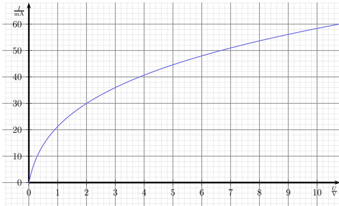
Eine Glühlampe mit obenstehender Kennlinie soll an einer Spannungsquelle mit  $U_0 = 12\text{ V}$  betrieben werden. Dabei soll ein Lampenstrom von  $I = 40\text{ mA}$  fließen. Dazu wird die Lampe über einen Vorwiderstand  $R_V$  betrieben.
