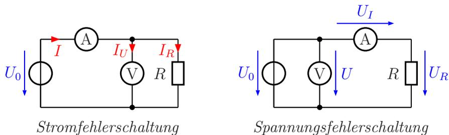
In der Stromfehlerschaltung stehen die beiden vertikalen Stromwege (der Widerstand und der Spannungsmesser) dicht nebeneinander. In der Spannungsfehlerschaltung liegen diese Zweige deutlich weiter auseinander. Man könnte diese Schaltung daher auch als „größer“ bezeichnen. Dann ist die Stromfehlerschaltung die „kleine“ Schaltung. Daraus machen wir den Merksatz:
