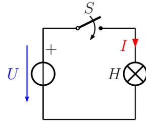
Wenn man einen Schalter in den Stromkreis einbaut, dann kann damit der gesamte Stromfluss im Stromkreis eingeschaltet oder unterbrochen werden. Der Schalter ist in der nebenstehenden Schaltung mit dem Kennbuchstaben  $S$  gekennzeichnet. Der Widerstand aus der vorangehenden Schaltung wurde außerdem ersetzt durch die mit dem Kennbuchstaben  $H$  gekennzeichnete Leuchte<sup>2</sup>.
