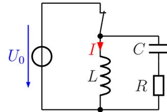
Eine Möglichkeit ist nebenstehend dargestellt. Der Spulenstrom kann dann über das R-C-Glied zunächst weiterfließen und dann abklingen. Die Werte für  $R$  und  $C$  müssen natürlich so bemessen werden, dass nicht unnötig viel Strom im eingeschalteten Zustand über das R-C-Glied fließt. Auf die Bemessung möchte ich hier aber nicht näher eingehen. Einzelheiten dazu sind z.B. hier zu finden:
