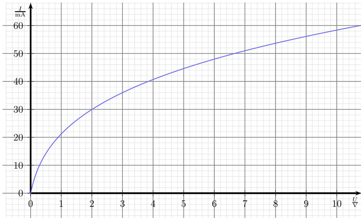
Eine Glühlampe mit obenstehender Kennlinie wird über einen Vorwiderstand  $R_V$  mit  $R_V = 220 \Omega$  an eine Spannung  $U_0$  mit  $U_0 = 10 \text{ V}$  angeschlossen. Ermitteln Sie mit Hilfe der Kennlinie zeichnerisch den sich ergebenden Strom  $I$  sowie die Lampenspannung  $U_L$ !
