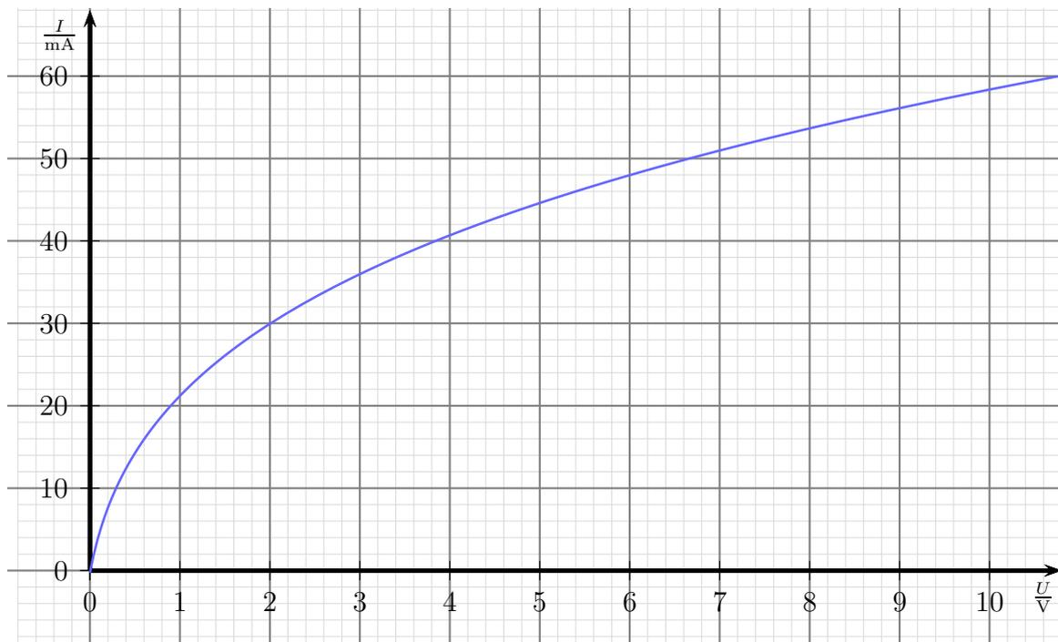
Bestimmen Sie von der Glühlampe mit obenstehender Kennlinie im Arbeitspunkt bei  $U = 6 \text{ V}$ :
