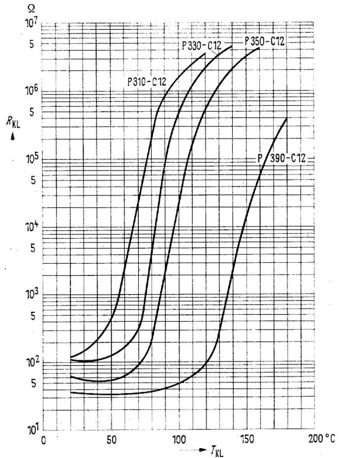
Baut man PTCs aus metallischen Werkstoffen auf, dann ist die Temperaturabhängigkeit sehr gering; dafür ist dann aber der nutzbare Temperaturbereich wesentlich größer.
