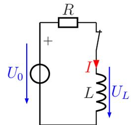
Die Induktionsspannung durch das Abschalten ist so groß, dass am Schalterkontakt ein Lichtbogen entsteht. Der Strom fließt also tatsächlich weiter, und zwar durch die (ionisierte) Luft. Das halten übliche Kontakte nicht lange aus, obwohl (wegen des hohen Widerstandes des Lichtbogens) der Lichtbogen nur kurz zustande kommt. Das bedeutet, dass man in der Praxis Maßnahmen ergreifen muss, die diesen Lichtbogen verhindern können.
