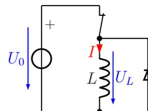
In diesem „Nebenstromkreis“ kann der Spulenstrom in Ruhe abklingen, ohne dass eine hohe Induktionsspannung entsteht und einen Lichtbogen am Schalter erzeugt.
