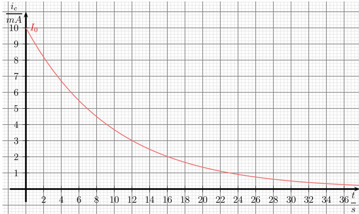
Wie man leicht sieht, sieht die Stromkurve praktisch genau so aus, wie die Spannungskurve. Das liegt am Ohmschen Gesetz, das am Entladewiderstand  $R$  gilt. Es sorgt dafür, dass Spannung und Strom zueinander **proportional** sind. Der Startwert für die Stromkurve – nennen wir diesen Strom  $I_0$  – kann mit dem Ohmschen Gesetz aus dem Spannungswert  $U_0$  bestimmt werden.
