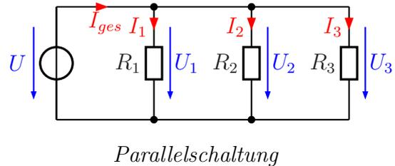
In einer Parallelschaltung ist die Spannung überall gleich groß.
