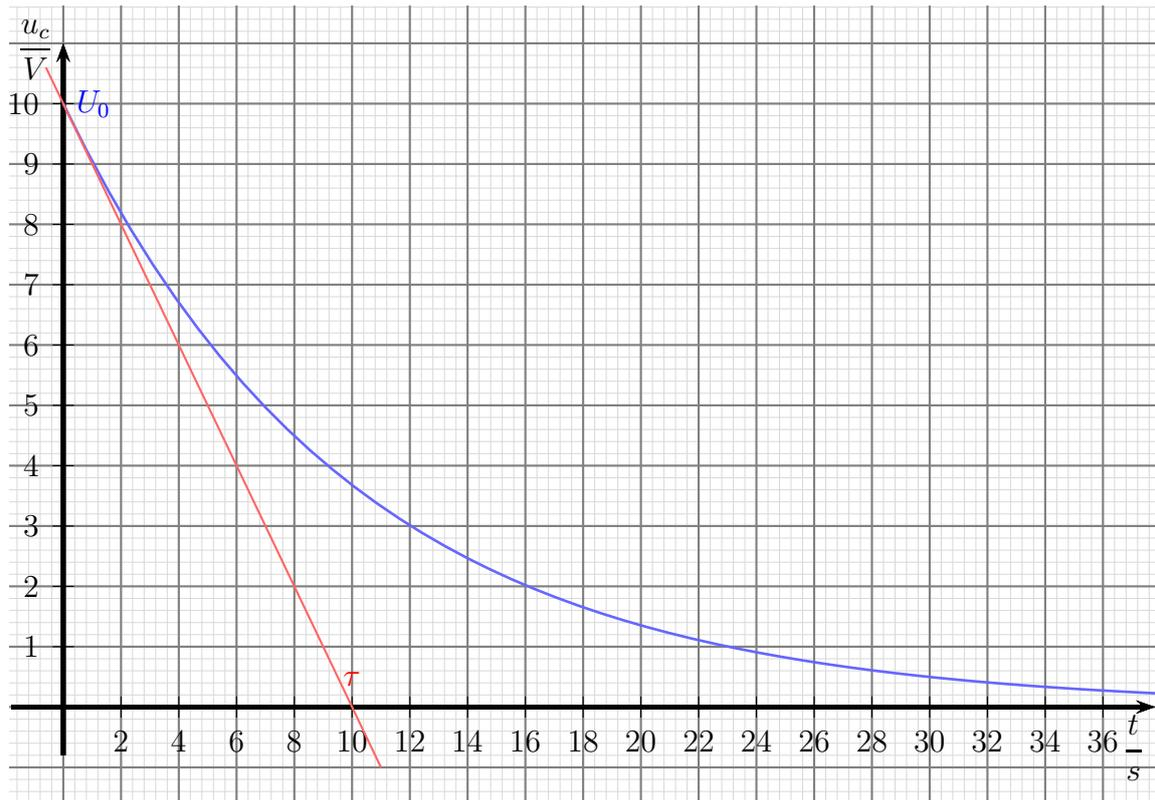
Legt man an die Kurve für den Spannungsverlauf bei  $t = 0$  eine Tangente an, dann schneidet diese Tangente bei  $t = \tau$  die  $t$ -Achse. Man kann an jeder beliebigen Stelle die Tangente anlegen, in jedem Fall liegt der erwähnte Schnittpunkt mit der  $t$ -Achse um die Zeit  $\tau$  nach rechts verschoben gegenüber dem Zeitpunkt, an den die Tangente angelegt wurde.
