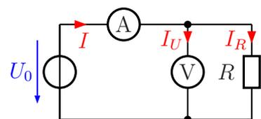
Ich nenne den Innenwiderstand des Spannungsmessers  $R_U$ . Die Ablesewerte an Spannungs- und Strommesser heißen einfach  $U$  und  $I$ . Damit kann ich den Strom  $I_R$  im Widerstand  $R$  berechnen:
