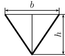
**Lösung:** Der Querschnitt der Rinne soll optimiert werden. Das ist die dreieckförmige Fläche. Damit erhalten wir die Hauptbedingung:
