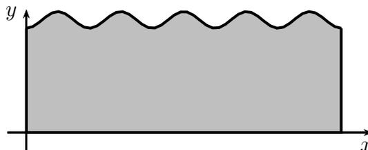
Das Gewindeprofil hat die Form einer Sinuskurve. Der Außendurchmesser eines Gewindes nach E27 beträgt 27 mm, der Kerndurchmesser 24,5 mm und die Gewindesteigung (Abstand zweier benachbarten Gewindegänge) 3,62 mm.
