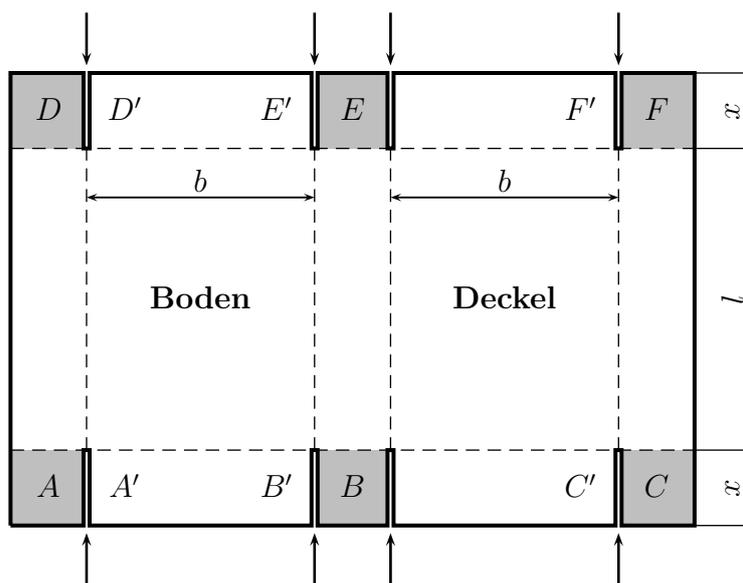
Nach dem Einschneiden werden die vier Rechtecke, die sich an den Boden anschließen, an den gestrichelten Linien senkrecht hochgeknickt. Dadurch entsteht das Bodenteil des eigentlichen Behälters. Nun werden die vier Laschen  $A$ ,  $B$ ,  $D$  und  $E$  umgeknickt und so mit den Seitenteilen des Behälters verklebt, dass  $A$  auf  $A'$ ,  $B$  auf  $B'$ ,  $D$  auf  $D'$  und  $E$  auf  $E'$  kommt.
