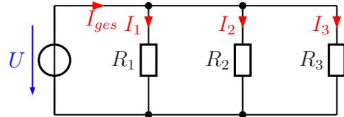
**Lösung:** Mit Hilfe von  $R_2$  und  $I_2$  kann die Spannung  $U$  über das Ohmsche Gesetz bestimmt werden. Die ist ja an allen Widerständen gleich groß. Mit dieser Spannung und  $R_1$  wird dann mit dem Ohmschen Gesetz der Strom  $I_1$  berechnet. Nun kann man die Kirchhoffsche Knotenregel zur Bestimmung von  $I_3$  verwenden. Mit dem Ohmschen Gesetz wird danach aus  $U$  und  $I_3$  der Widerstand  $R_3$  berechnet.
