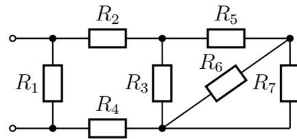
**Lösung:** Hier kommt es darauf an, Teilschaltungen zu finden, die entweder eine reine Reihen-, oder eine reine Parallelschaltung darstellt. In dieser Schaltung ist das zunächst nur mit  $R_6/R_7$  der Fall. Diese Widerstände sind parallel geschaltet. Werden sie zu  $R_{67}$  zusammengefasst, ergibt sich nebenstehende Ersatzschaltung.
