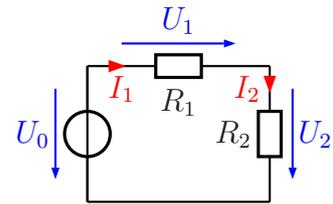
**Lösung:** Das erste, was man sofort angeben kann, ist die Tatsache, dass  $I_1$  und  $I_2$  gleich sind, da es sich um eine Reihenschaltung handelt. Bevor jedoch eine Teilspannung oder ein Strom berechnet werden kann, muss der Ersatzwiderstand der Reihenschaltung  $R_E$  bestimmt werden.
