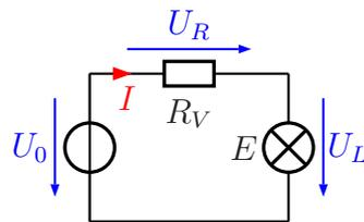
**Lösung b)** Zunächst wird die Lampenspannung  $U_L$  im Diagramm abgelesen, die sich durch den vorgegebenen Strom von  $I = 40 \text{ mA}$  ergibt:
