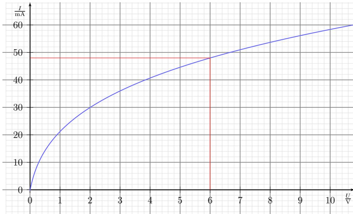
**Lösung a)** Der zu der vorgegebenen Spannung von  $U = 6\text{ V}$  gehörende Strom wird aus dem Diagramm abgelesen:
