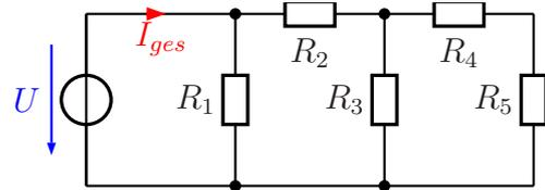
**Lösung:** Um den Gesamtstrom bestimmen zu können, muss der Ersatzwiderstand der gesamten Schaltung bekannt sein. Dieser wird schrittweise berechnet. Dazu werden jeweils Reihen- bzw. Parallelschaltungen zusammengefasst. Als erstes fassen wir  $R_4$  und  $R_5$  zu  $R_{45}$  zusammen, wie nebenstehend dargestellt ist.
