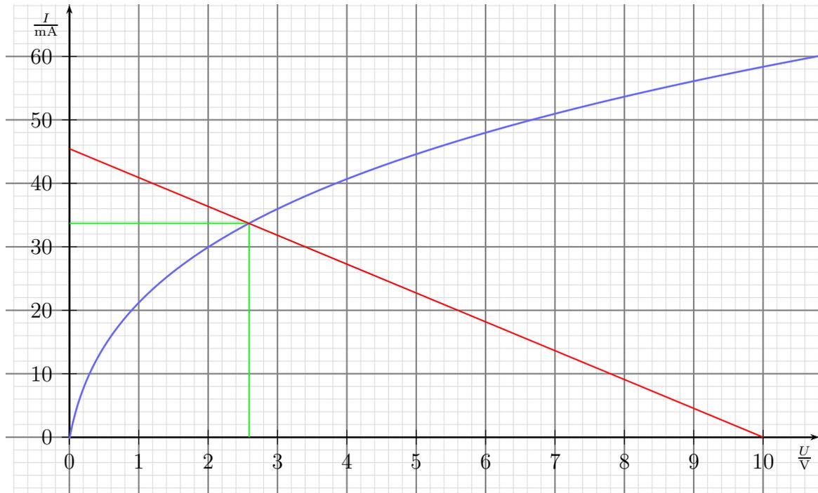
**Lösung:** Zunächst wird der Kurzschlussstrom  $I_K$  berechnet, der sich ergeben würde, wenn man die Glühlampe kurzschließen würde.
