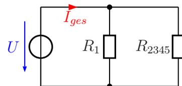
$$R_{2345} = R_2 + R_{345} = 200 \Omega + 600 \Omega = 800 \Omega$$
