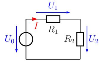
**Lösung:** Da der Widerstand  $R_1$  sowie der Strom  $I$ , der hindurch fließt, bekannt sind, kann zunächst die Teilspannung  $U_1$  berechnet werden. Mit Hilfe der Gesamtspannung  $U_0$  kommt man dann auf die Teilspannung  $U_2$ . Mit dieser und dem Strom  $I$  wird dann der Widerstand  $R_2$  bestimmt.
