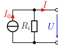
Die reale Stromquelle kann aus einer idealen Stromquelle und einem Widerstand nachgebildet werden. Dieser Innenwiderstand ist anders, als in der Spannungsquelle, nicht in Reihe, sondern parallel zur idealen Stromquelle geschaltet. Dadurch ist die ideale Stromquelle immer belastet, Leerlauf ist bekanntlich ja nicht zulässig. Durch die Verwendung idealer Bauelemente in der Ersatzschaltung wird die reale Stromquelle gut berechenbar.
