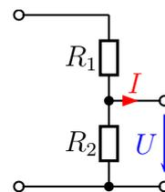
Belasten sie nun die Schaltung mit einem Lastwiderstand von  $R_L = 20 \Omega$ . Welche Ausgangsspannung ergibt sich mit dieser Belastung?
