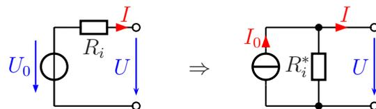
Man kann nun für beliebige Belastungen rechnen. Vermutlich ist es jedoch am einfachsten, wenn man die beiden Belastungsfälle „**Kurzschluss**“ und „**Leerlauf**“ zugrunde legt. Beginnen wir die Berechnung mit dem Kurzschlussfall.
