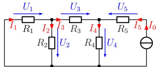
Zunächst kann der Ersatzwiderstand  $R_{12}$  der Parallelschaltung aus  $R_1$  und  $R_2$  bestimmt werden.
