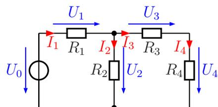
Hier können zunächst die Widerstände  $R_3$  und  $R_4$  zu  $R_{34}$  zusammengefasst werden. Für die Reihenschaltung gilt:
