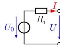
Dieses Verhalten bekommt man mit nebenstehender Schaltung in den Griff. Man setzt die reale Spannungsquelle einfach aus einer idealen Spannungsquelle und einem idealen Widerstand – dem sogenannten **Innenwiderstand**  $R_i$  – zusammen. Je nach Laststrom  $I$  ist die Klemmenspannung  $U$  etwas kleiner, als die Urspannung  $U_0$ . Durch die Verwendung idealer Bauelemente in der Ersatzschaltung wird die reale Spannungsquelle gut berechenbar.
