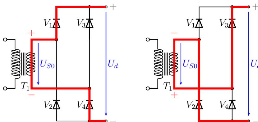
Obenstehend sind die entsprechenden Stromwege eingetragen, links für die positive und rechts für die negative Halbwellen.
