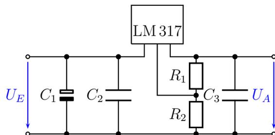
Machen wir dazu ein Zahlenbeispiel. Mit dem LM 317 soll eine Spannung von  $U_A = 12\text{ V}$  erzeugt werden. Der Widerstand  $R_1$  ist auf  $R_1 = 100\ \Omega$  festgelegt worden. Gesucht ist der Widerstand  $R_2$ . Wenn am Widerstand  $R_1$  eine Spannung von  $U_1 = 1,25\text{ V}$  abfällt,
