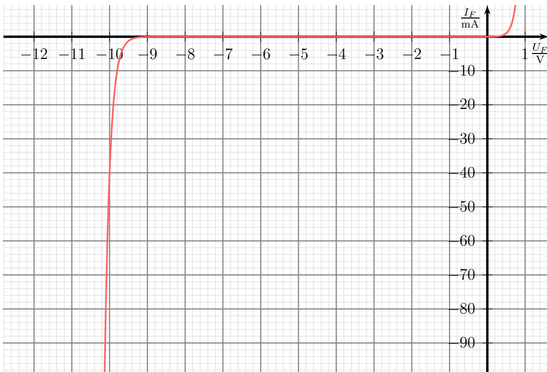
Typische Kennlinie einer Z-Diode
