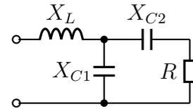
**Lösung:** Um das Problem lösen zu können, stelle ich die Formel auf, mit deren Hilfe  $\underline{Z}$  aus den Blind- und Wirkwiderständen bestimmt wird. Dabei setze ich die unbekanntene Größe  $\underline{X}_{C2}$  an mit:
