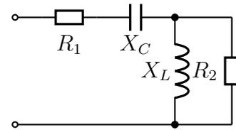
**Lösung:** Zuerst werden die Komplexen Widerstände bestimmt.
