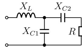
**Lösung:** Um das Problem lösen zu können, stelle ich die Formel auf, mit deren Hilfe  $Z$  aus den Blind- und Wirkwiderständen bestimmt wird. Dabei setze ich die unbekanntene Größe  $X_{C2}$  an mit:
