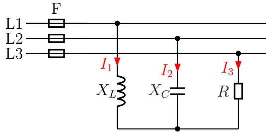
**Lösung:** Um einen besseren Überblick zu erhalten, wird die Schaltung zunächst etwas umgezeichnet. Dabei werden aus dem Dreiphasen-Wechselspannungsnetz nur die Spannungen  $U_{12}$  und  $U_{23}$  verwendet; mit diesen wird aber trotzdem das komplette Netz vollständig beschrieben. Zur besseren Orientierung habe ich die Punkte, die die Außenleiter **L1**, **L2** und **L3** sowie den Sternpunkt **N** bezeichnen, mit in die Schaltung eingetragen.
