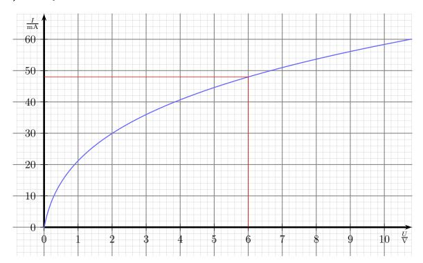
**Lösung a)** Der zu der vorgegebenen Spannung von  $U=6\,\mathrm{V}$  gehörende Strom wird aus dem Diagramm abgelesen:
