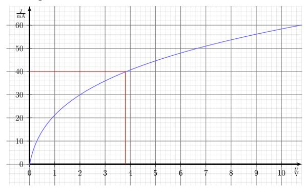
Eine Glühlampe mit obenstehender Kennlinie soll an einer Spannungsquelle mit  $U_0=12\,\mathrm{V}$  betrieben werden. Dabei soll ein Lampenstrom von  $I=40\,\mathrm{mA}$  fließen. Dazu wird die Lampe über einen Vorwiderstand  $R_V$  betrieben.
