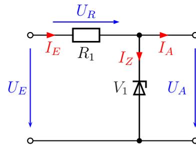
**a)** Bestimmen Sie einen geeigneten Vorwiderstand  $R_1$  aus der E12-Reihe, so dass ein möglichst großer Laststrom  $I_A$  entnommen werden kann. Beachten Sie, dass die Schaltung vertragen muss, dass der Laststrom  $I_A$  auch mal Null werden kann. Die Toleranz dieser Widerstände beträgt 10 %.
