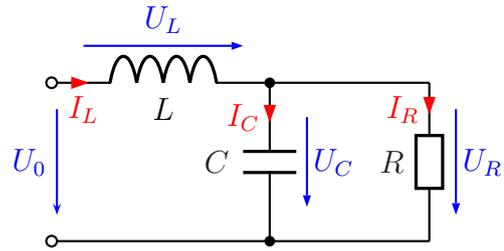
Die Schaltung wird an eine Spannung  $U_0$  angeschlossen. Gesucht ist der Strom  $I_R$ .
